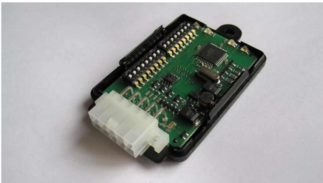
Вариатор со снятой защитной крышкой.
